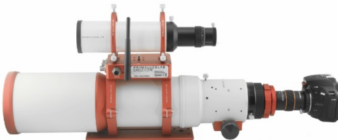
Reflex digitale Nikon collegata in proiezione (con lente di Barlow 3x) al rifrattore apocromatico in questo modo lo utilizza a 650mm x 3 = 1950mm di focale (f18.75)
